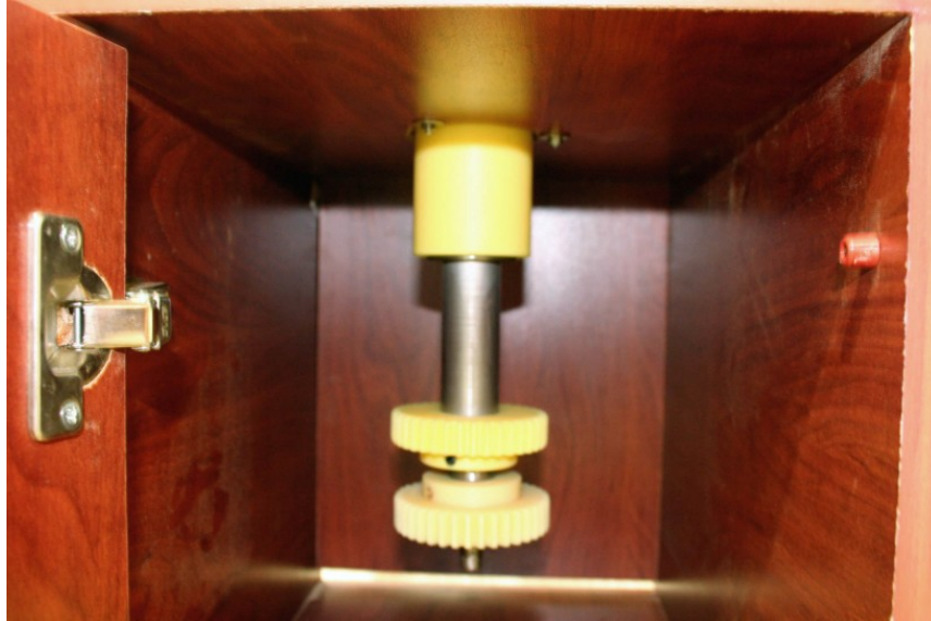
Şekil 2.2 Sistemde motorların dönüş hareketini panele aktaracak alan dişliler
